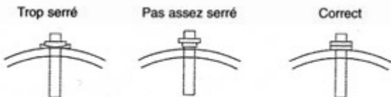
En vous conformant à ces dessins de détail, vissez le panneau au complet. Enfoncez toujours les vis au sommet d'une ondulation, juste avant le début d'une nouvelle rangée du panneau. Pour les chevauchements, vissez la section au complet à chaque rangée. Vissez à travers les fermetures à chaque ondulation à l'extrémité supérieure de chaque panneau. Pour visser au travers des pannes en métal épais, ayez recours à des « Driller Screws ».
